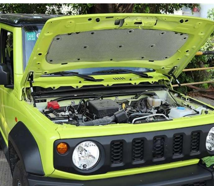
Función: Evita que la alta temperatura del motor dañe la pintura exterior del capot, reduce levemente el sonido del motor hacia la cabina
